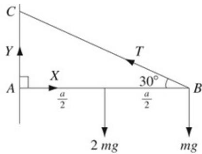
**a**  $M(A) \quad 2mg \times \frac{a}{2} + mga = Ta \sin 30^\circ$  ←
