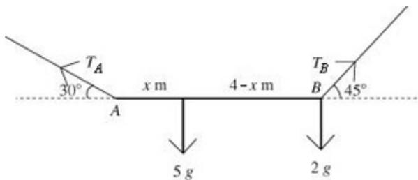
$$\mathbf{a} \quad \text{R}(\rightarrow) \quad T_A \cos 30^\circ = T_B \cos 45^\circ,$$
